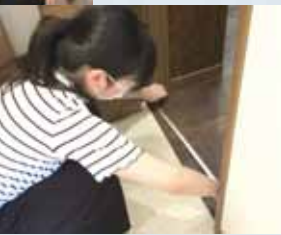
▲ 出入り口の幅を計測
